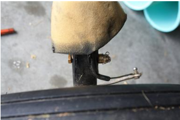
The new axle/gear leg bolt.
